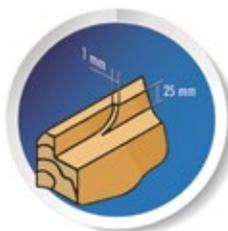
En el cepillado de solapes, el GR120P es el único Cepillo, además de CE120P, que permite un cepillado lateral de hasta 1 mm y una altura de corte máxima de 25 mm.
