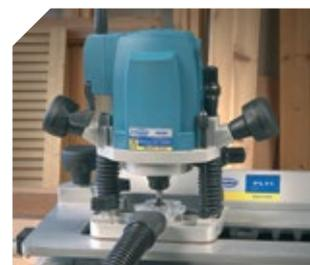
Sistema de bloqueo total de la profundidad de fresado, ideal para la realización de ensamblajes mediante lazos u otros procesos que requieran un total bloqueo del cabezal.
