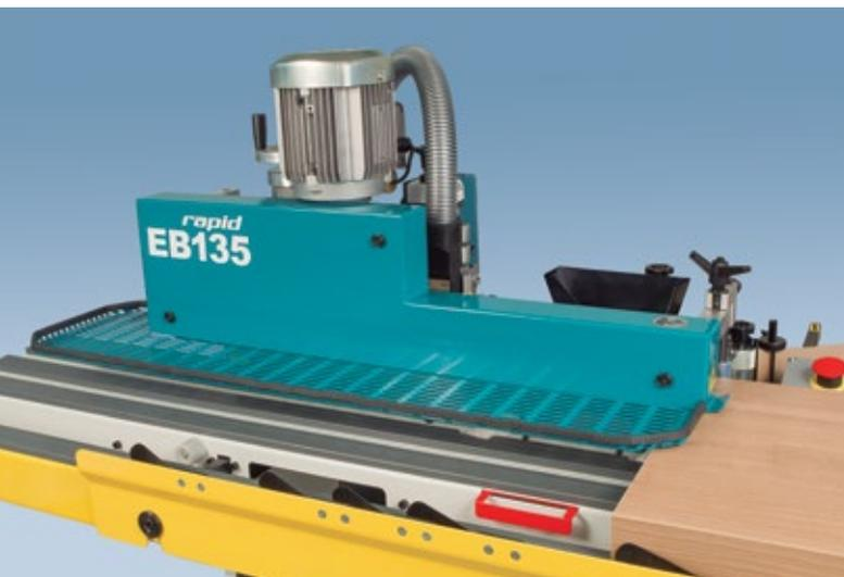
Para asegurar un buen aplacado del canto, la EB135 incorpora un alimentador el cual proporciona un aplacado asistido y sin esfuerzo.
