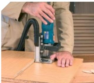
Ensamblaje en medio del tablero
