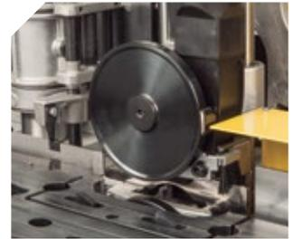
Perfilador de rápida regulación mediante contador digital. Permite el perfilado en bisel o con diferentes radios. Con rascador de doble efecto para un acabado perfecto libre de restos de cola. Retestado automático.
