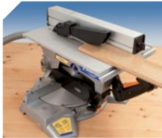
Nueva mesa superior, más amplia, para trabajos auxiliares. El corte es regulable de 0 a 55 mm y dispone de un regle con escala milimetrada para facilitar el corte. Permite adaptar una escuadra (opcional) para cortes guiados en ángulo. (ver accesorios opcionales pág. 76)
