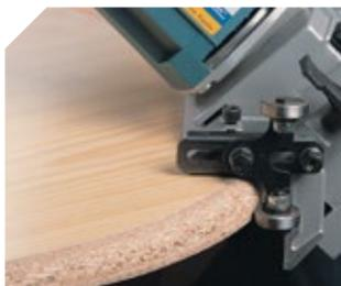
Copiadore de radios opcional. Posibilidad de perfilar el canto en radio (R=5, 10 ó 15), usando las cuchillas de radios ref. 9841005.
