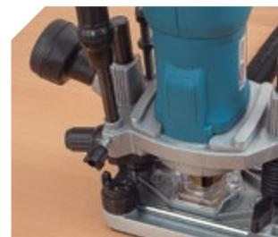
Sistema de ajuste fino de la profundidad de fresado (décimas de mm) y milimétrico más preciso y estable. 6 topes de profundidad de ajuste rápido.
