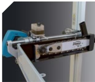
Dotada de una eficaz sierra de cadena, la cual proporciona un corte limpio y sin esfuerzo. Equipada con protecciones que evitan el contacto con la sierra de cadena y de toma para aspiración externa.
