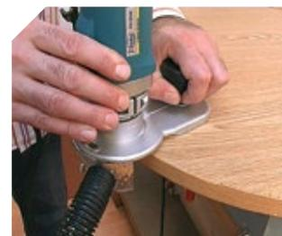
El cabezal opcional CA56U permite el perfilado ininterrumpido de los cuatro cantos de un panel. Con una gran base de apoyo y pomo auxiliar para la sujeción. Ideal para la realización de trabajos de enrasado en el borde del panel.
