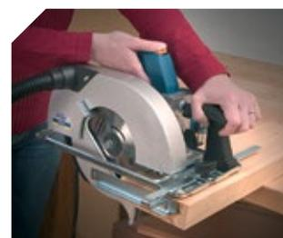
Permite realizar cortes de hasta 70 mm.
