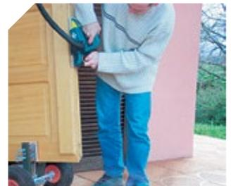
Es posible bloquear las ruedas para una utilización estacionaria; lo que permite realizar cualquier intervención en el canto del panel o puerta.
