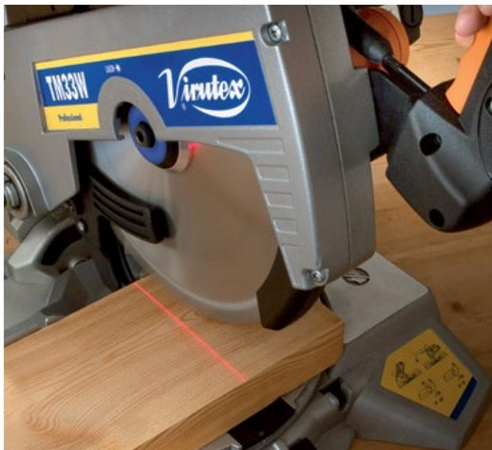
Equipada con láser de precisión para facilitar el corte. Activación automática del mismo al poner la máquina en marcha. Incluye interruptor on/off, ideal para desactivarlo al trabajar con la mesa superior.
