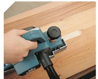
Equipado con toma para la conexión a un aspirador (opcional) externo.
