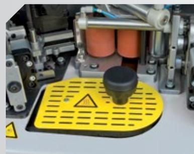
Depósito de cola con recubrimiento de Teflón® anti-adherente. Cantidad de cola a depositar sobre el canto regulable.
