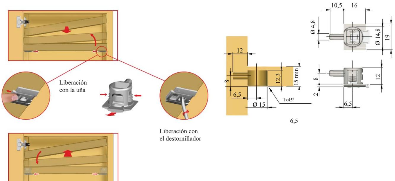
PK2 es el nuevo concepto de soporte de unión para estanterías de madera, permite unir cualquiera de las partes y la plataforma, incluyendo la parte inferior y la parte superior, sin necesidad de utilizar ningún accesorio de conexión adicional.
