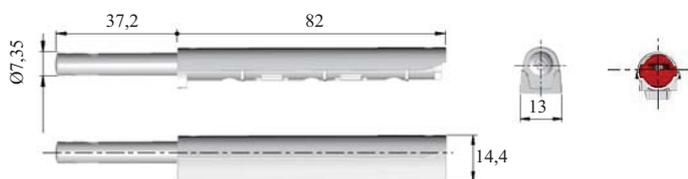
Nuevo sistema automático de apertura de puertas sin tiradores. Mecanismo interior silencioso y de gran durabilidad. Regulable.
