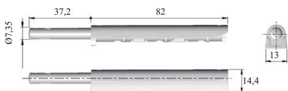
Nuevo sistema automático de apertura de puertas sin tiradores. Mecanismo interior silencioso y de gran durabilidad. Regulable.
