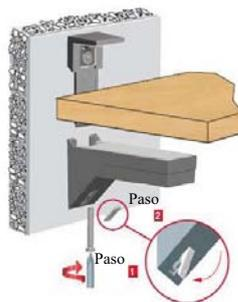
Montar parte inferior para colocar el estante y ajustar
