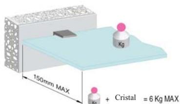
Es adecuado para los estantes de 5 a 10 mm de espesor. Su sólida estructura garantiza una capacidad de carga de 6 Kg, incluyendo el peso de la plataforma de vidrio, para cada soporte con un estante de 150mm de profundidad.
