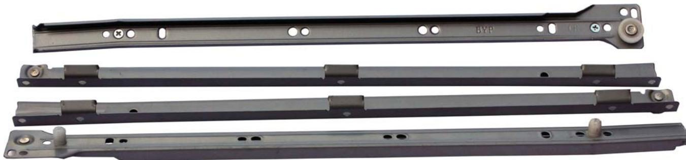
La fijación Clamp se consigue por medio del plegado de tres aletas laterales practicadas en el cuerpo de la guía y garantiza una perfecta sujeción y un apoyo óptimo de la guía al lateral del cajón. Este tipo de fijación permite montar la guía más rápido y sin emplear tornillos.
