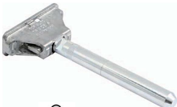
Para estantes de espesor mínimo 25mm. hasta 30mm. el soporte queda parcialmente embutido, el estante queda separado de la pared 3mm. Para estantes superiores a 30mm. puede quedar totalmente embutido, se precisa hacer un cajeado doble en la madera según se indica.
